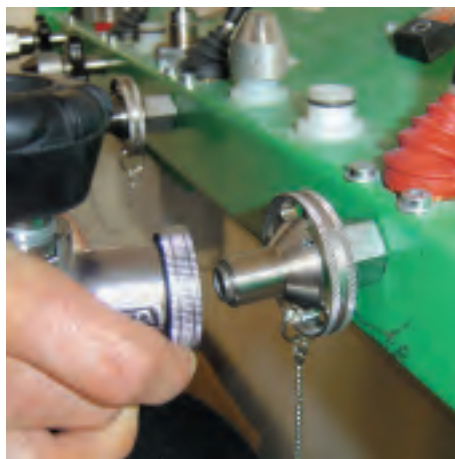
alphaCLICK raccordo per sostituzione rapida della bombola
